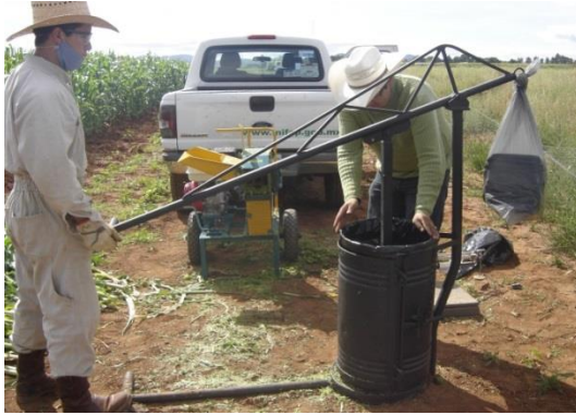
Figura 2. Llenado y apisonado del forraje en microsilo mediante palanca manual.
