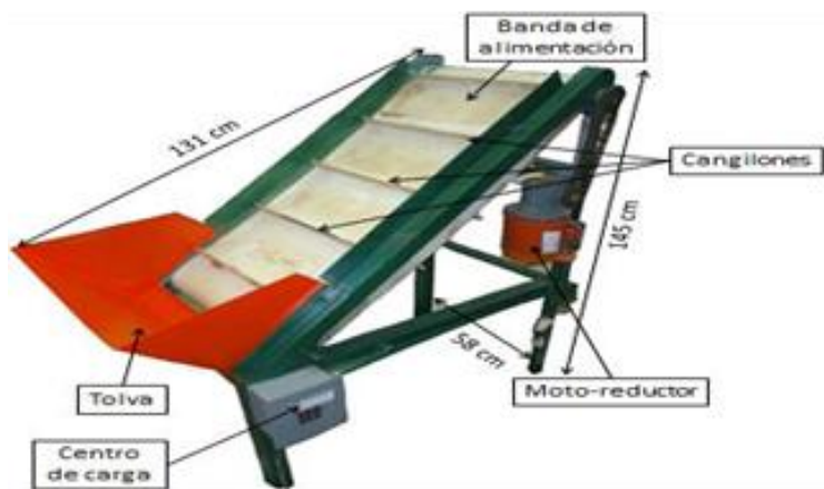
Figura 10. Partes y dimensiones del módulo alimentador y transportador de cangilones
