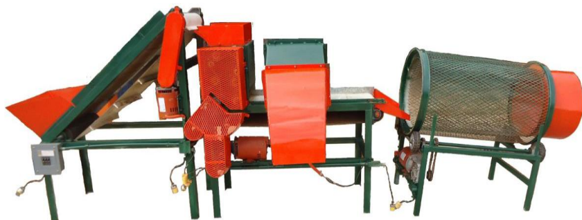
Figura 1.- Estructura completa de la desgranadora y seleccionadora de ajo para semilla.
