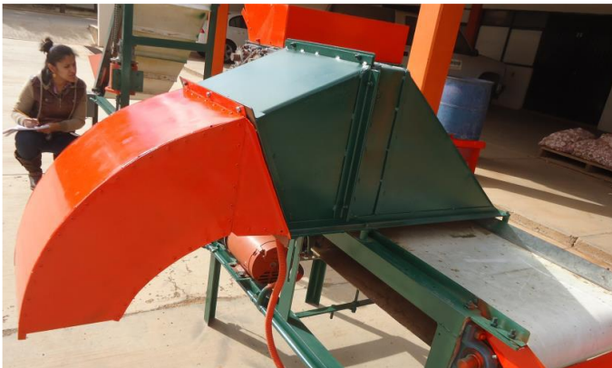
Figura 6. Módulo de extracción de impurezas
