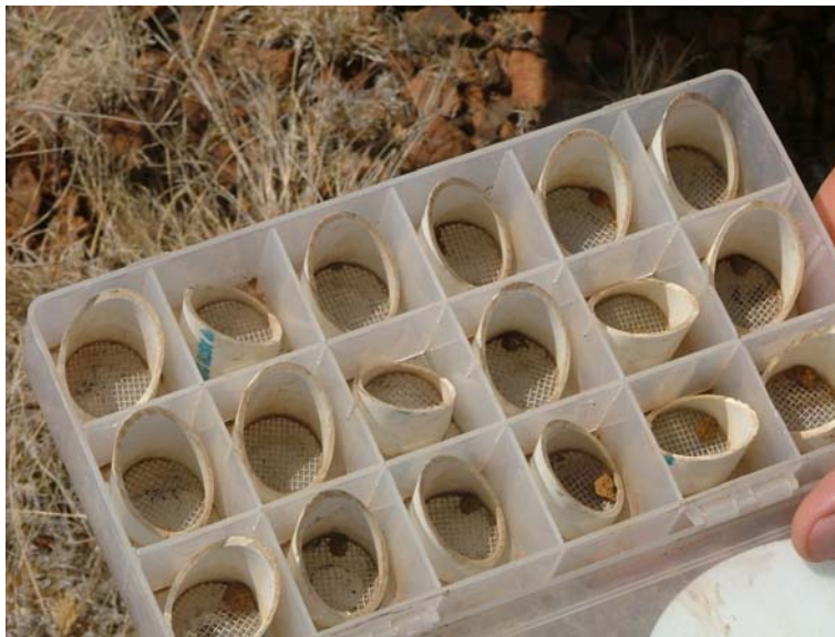
Figura 4. Determinación de estabilidad de agregados del suelo.
