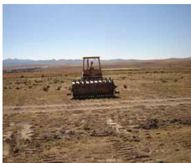
Figura 5.- Rodillo aerador utilizado para descompactar la superficie del suelo para preparar una cama de siembra.
