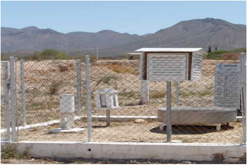
Figura 28.- Estación climatológica equipada con pluviómetro estándar y automatizado.
