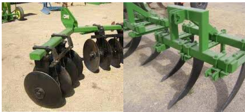
Figura 33.- Implementos agrícolas bordeadora y subsuelo utilizados para la construcción de bordos a nivel.
