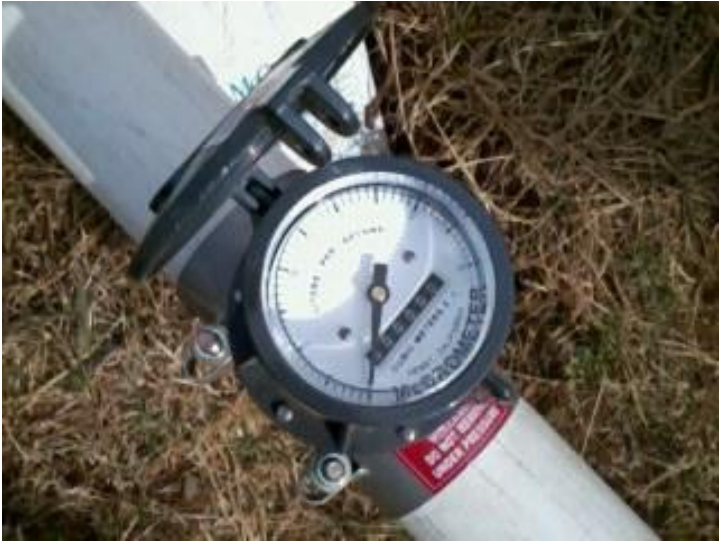
Figura 4.- Flujómetro de volumen y gasto
