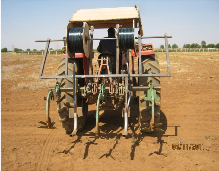
Figura 2.- Dispositivo mecánico para colocación de cintilla sub-superficial
