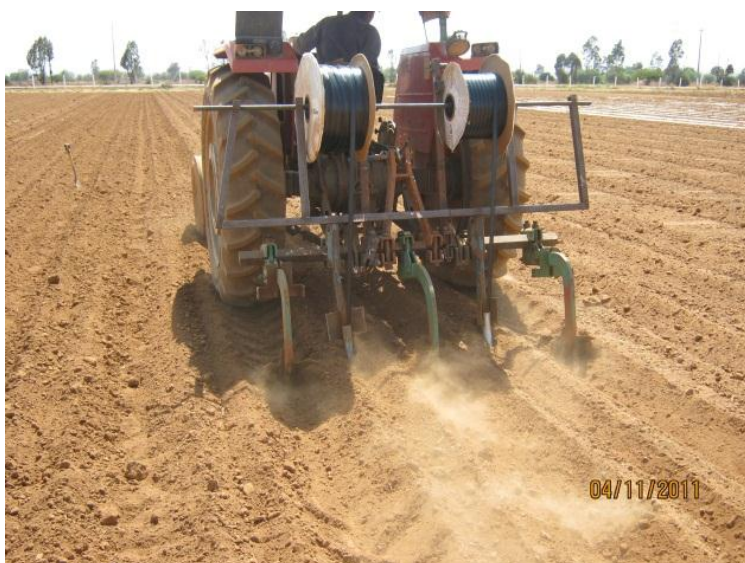
Figura 3.- Operación del dispositivo para colocación de cintilla sub-superficial
