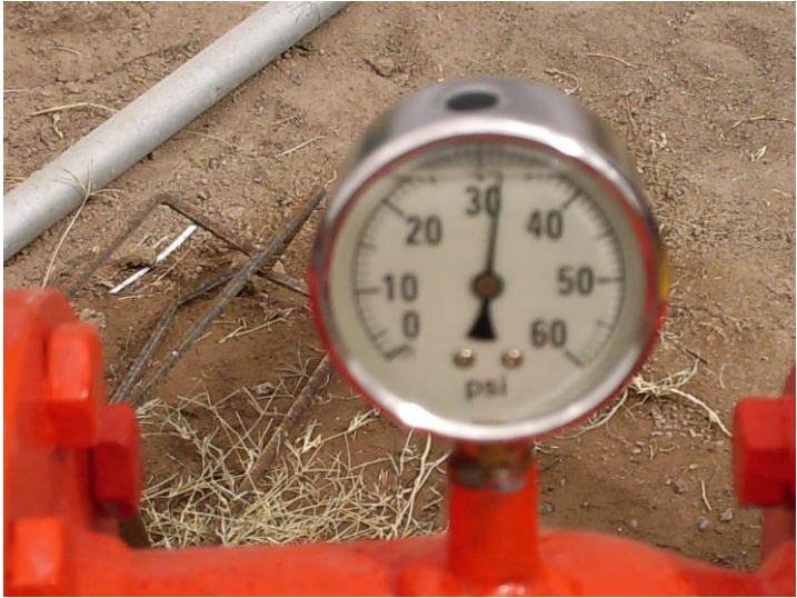
Figura 5.- Manómetro medidor de presión
