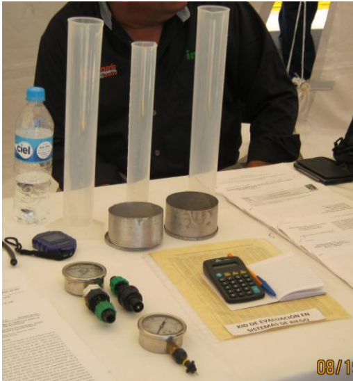
Figura 6.- Equipo para evaluación de sistemas de riego
