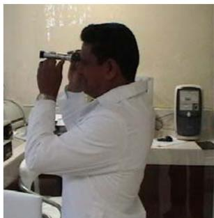
Se dirige el refractómetro a una fuente de luz y se ajusta a su ojo; al enfocar se da una lectura en la escala del refractómetro en grados brix
