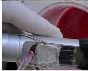
Se ponen de 3 a 4 gotas en la parte cristalina del refractómetro
