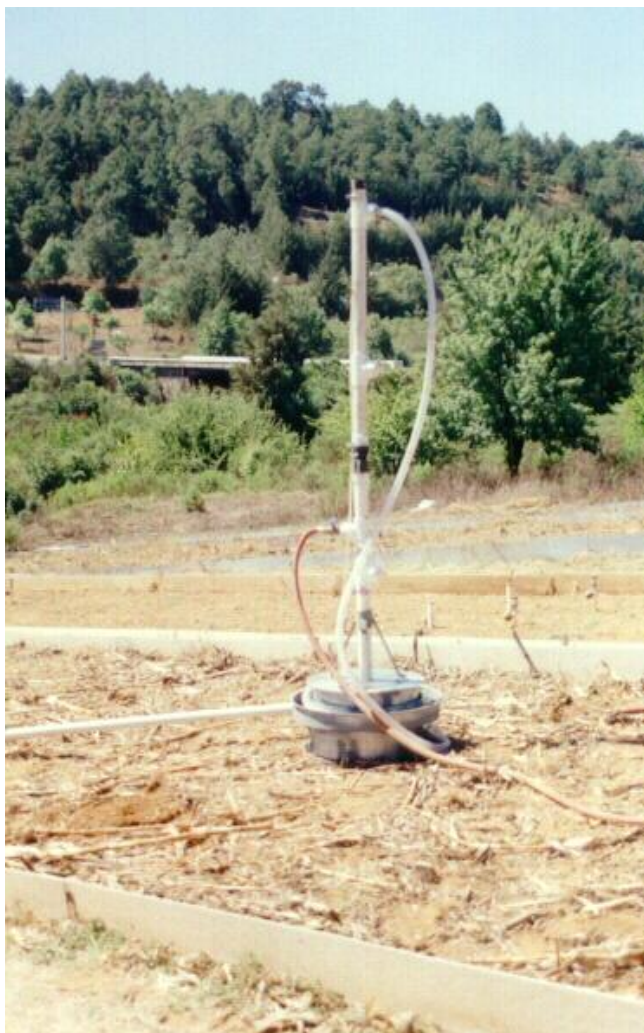
Figura 1. Determinación del parámetro K_r en un lote de escurrimiento de labranza de conservación en Santa Isabel de Ajuno, Pátzcuaro, Michoacán.
