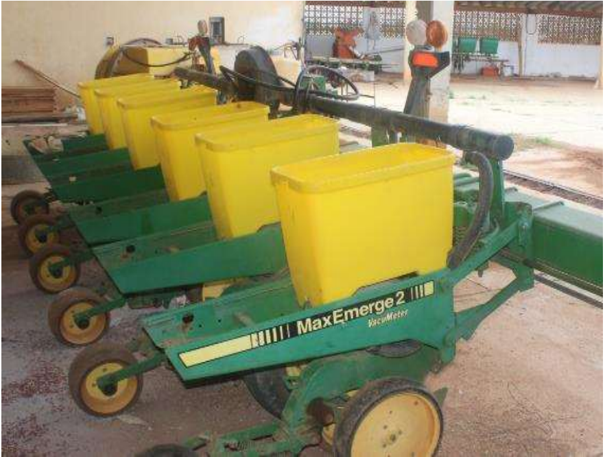
Figura 9. Sembradora de precisión para siembra tradicional.
