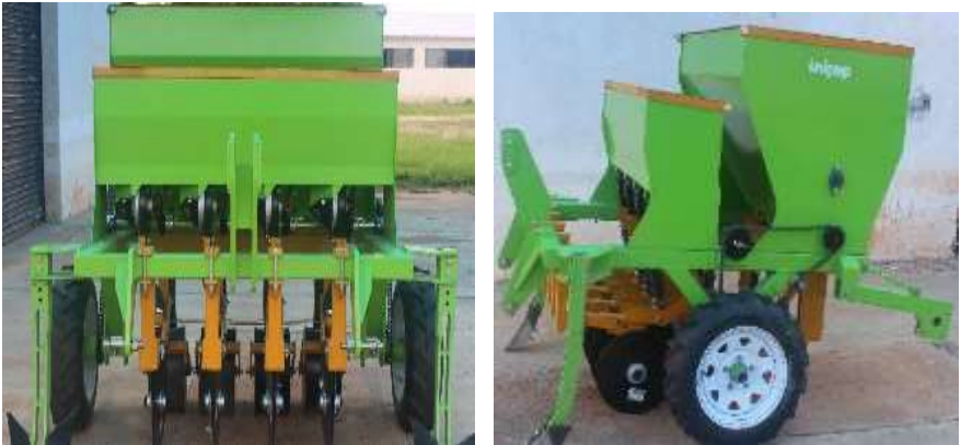
Figura 10. Sembradora mecánica de precisión para siembra de frijol en camas.
