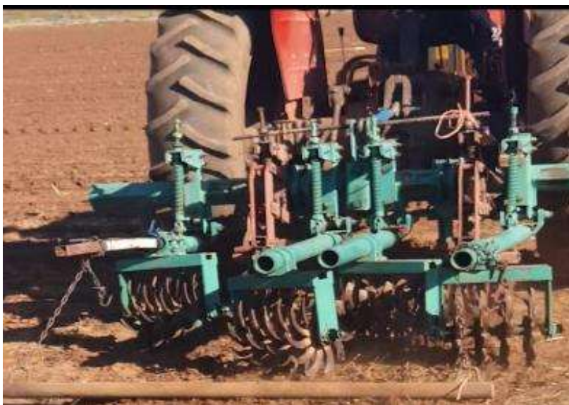
Figura 12. Cultivadora tipo Lilliston de dos surcos para eliminar la maleza antes de la germinación del frijol.
