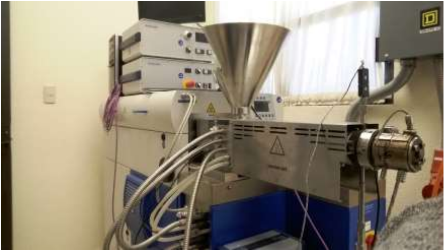
Figura 1. Extrusor utilizado para la elaboración de la harina de frijol.
