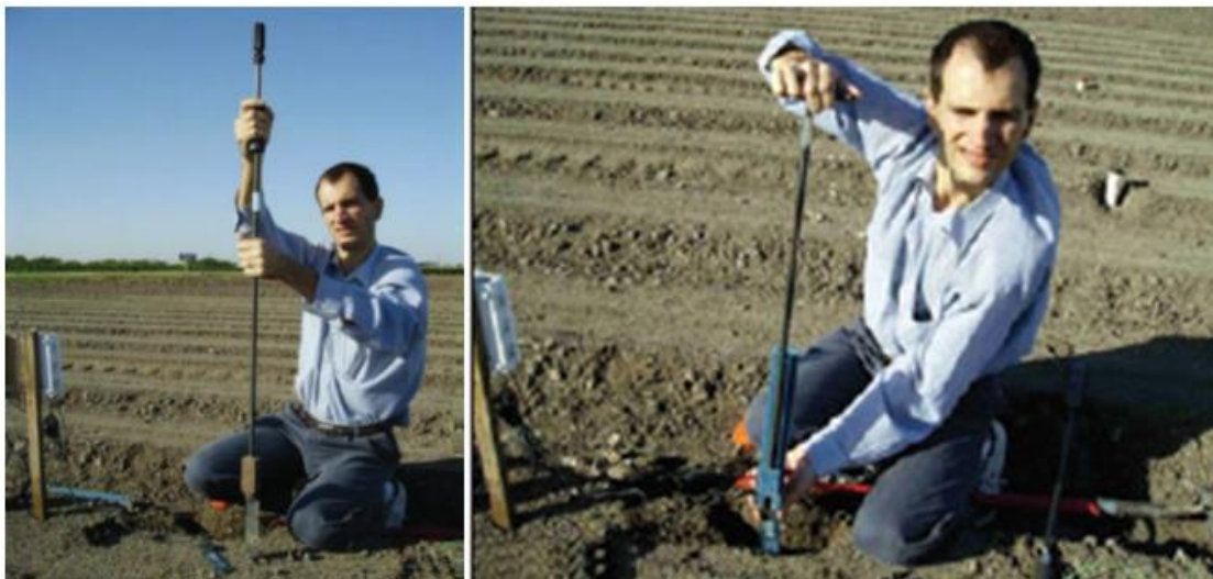
Figura 4.8. Uso de una herramienta especial para instalar sensores ECH2O®: una lámina de acero de la misma medida que el sensor se martilla hacia el suelo (izquierda) antes de insertar y empujar el sensor con otra herramienta (Derecha).
