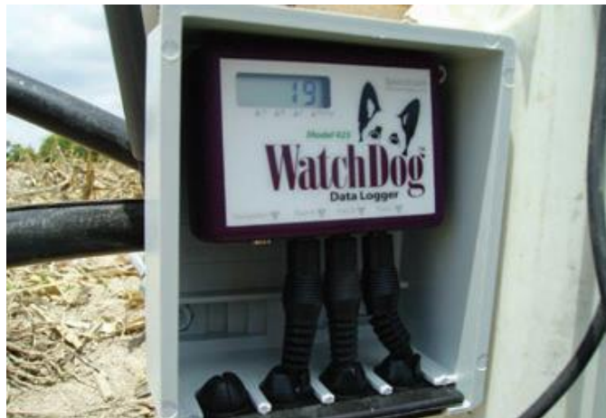
Figura 5. Sensores Watermark® conectados a un sistema de registro de datos WatchDog® (de hasta 3 sensores).
