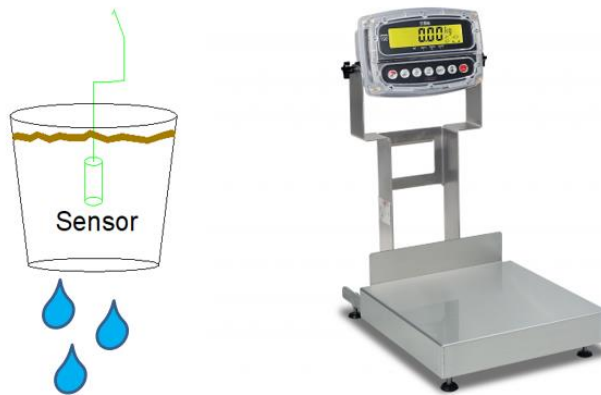
Figura 4.14.- Calibración de sensores con peso del suelo húmedo
