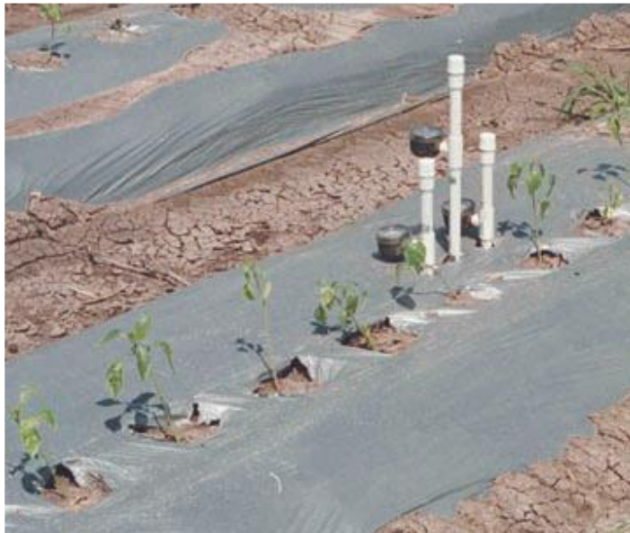
Figura 11. Estación de tres tensiómetros instalados a diferentes profundidades del suelo.
