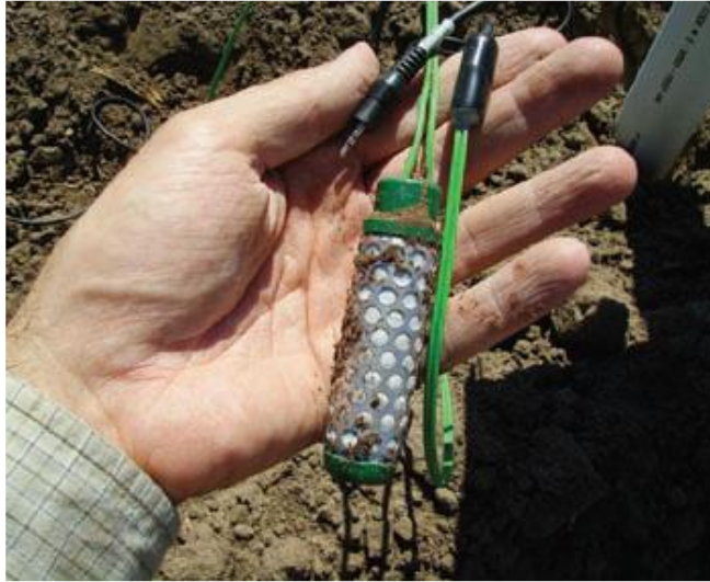
Figura 4.3. Sensor Watermark® antes de su instalación.
