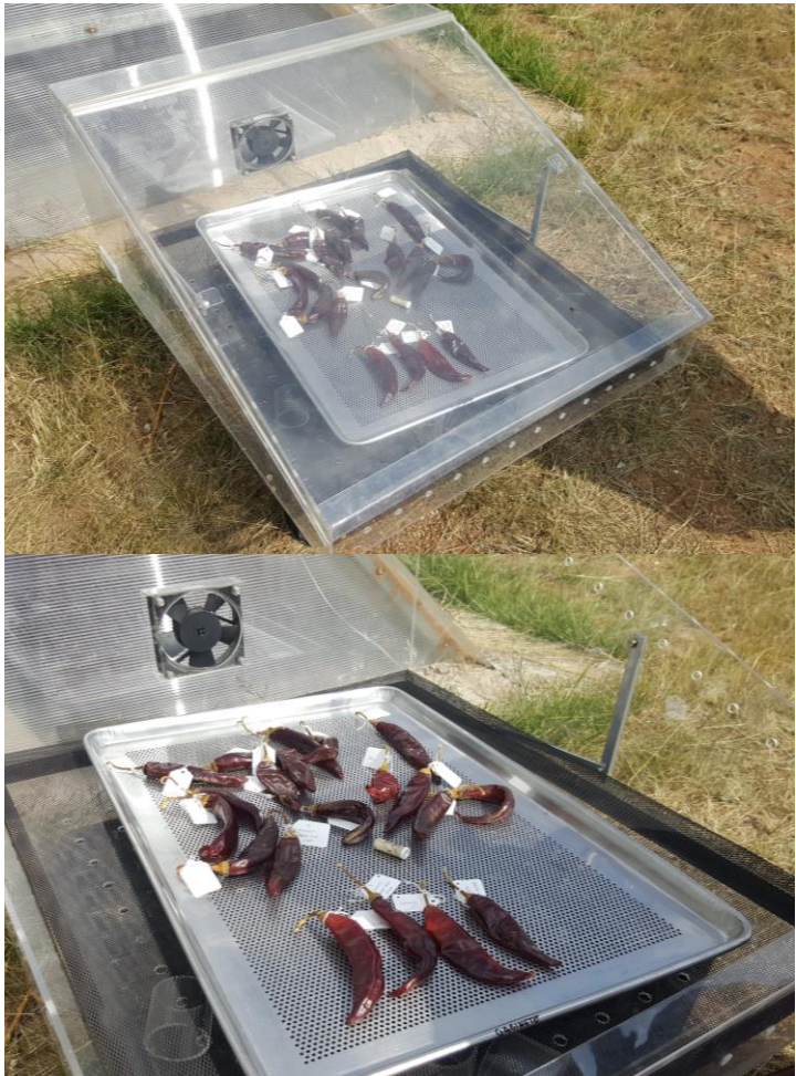
Figura 1. Deshidratador solar. Planta termosolar deshidratadora de productos agrícolas del estado de Zacatecas.
