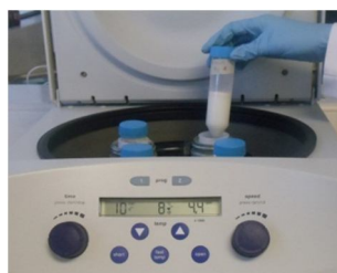
Centrifugar leche 3000 RPM 20 min
