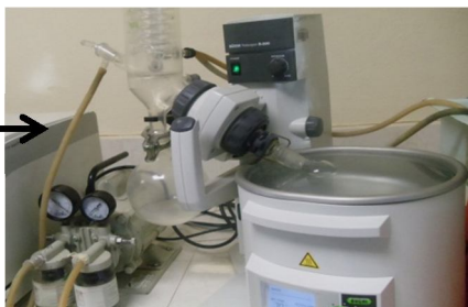
Agregar reactivo de terminación, recuperar fase superior y rotaevaporar
