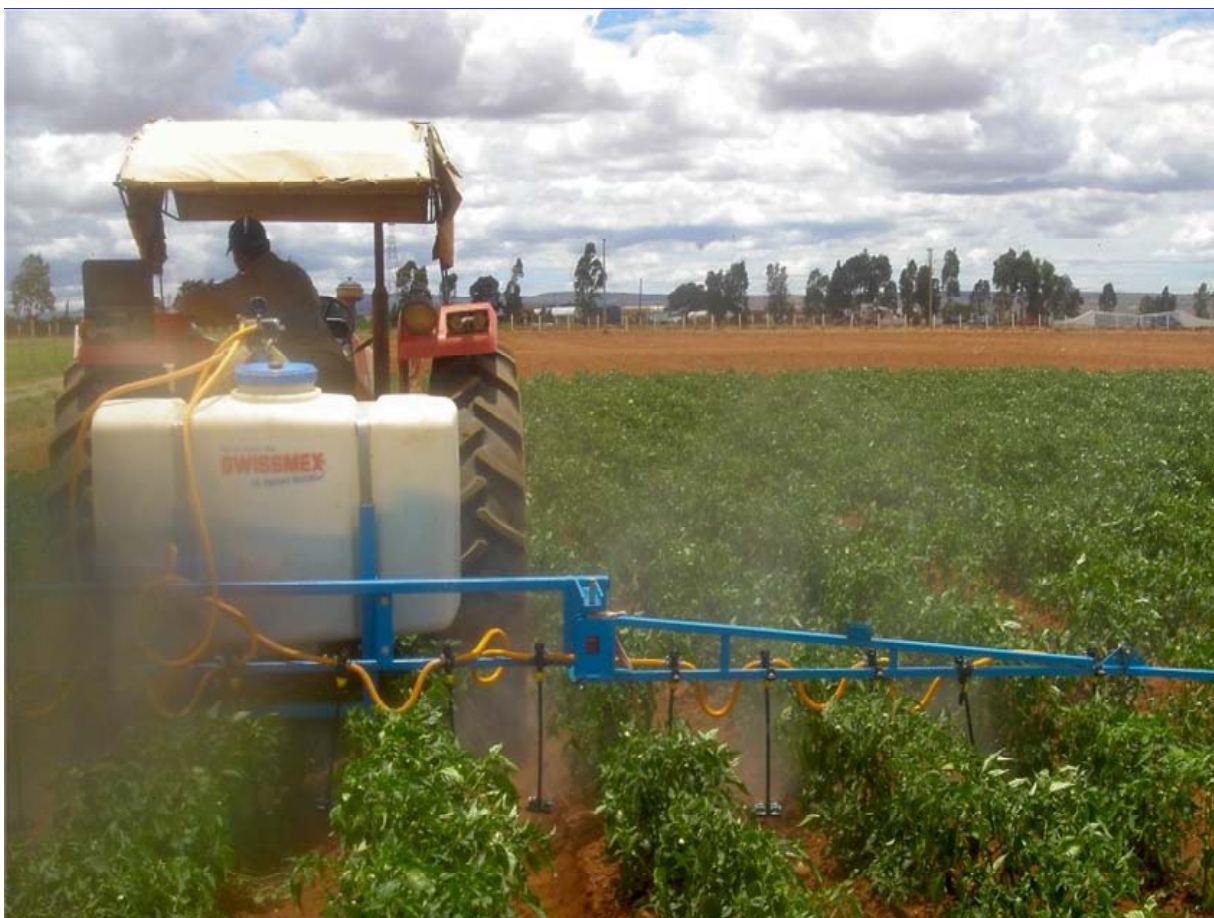
Figura 9. Aspersora de tractor donde se muestra el aguilón de aspersión con bajadas de las boquillas para dirigir la aspersión de abajo hacia arriba para colocar la mayor cantidad de producto sobre el envés de las hojas.
